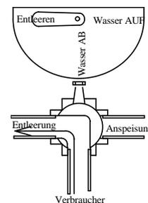
**Es ist unbedingt notwendig die Funktion des Abdrehens und das sich Entleeren in den Schacht zu überprüfen**, da für Folgeschäden welcher Art auch immer, durch unsachgemäße Handhabung, seitens des Erzeugers nicht gehaftet werden kann.
