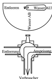
In der Stellung „ENTLEEREN“ gibt der Dreiwegkugelhahn den Durchgang zwischen Verbraucher und der dritten Öffnung frei bei welcher keine Leitung angeschlossen ist und daher das Wasser, welches sich noch in der Leitung befindet, in den Schacht ausfließen kann.
